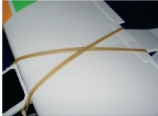
Für die Tragflächenbefestigung kleben Sie die Buchenrundstäbe in die vorher freigelegten Rumpfb Bohrungen. Mit mehreren Gummibändern wird die Fläche genügend der Flugbelastungen auf dem Rumpf gehalten.
