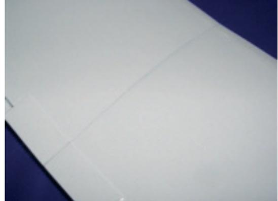
Nach dem probeweisen Zusammenstecken der Tragflächenhälften, kann der Sperrholz-Tragflächenverbinder unter reichlicher 5Minuten-Epoxydharzfüllung der Verbinder-Aufnahme auf einer Seite eingeharzt werden. Bitte beachten Sie die Dosierungsangaben des Herstellers für ein präzises Zusammenmischen von Harz/Härter. Erst im Anschluss werden beide Flächenhälften miteinander verklebt. Übergequollenen Klebstoff bitte sofort entfernen!
