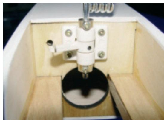
Das Bugfahrwerk mit Steuerarm und Stellringen in die Rumpfhalterung einsetzen. Der Steuerarm muss, damit ausreichender Lenkweg vorhanden ist, etwas nach vorn versetzt festgestellt werden.
