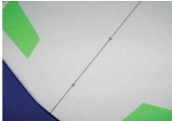
Bohren Sie mit einem 3mm Bohrer durch die zuvor ermittelten Punkte. Die Bohrungen sollten Sie im Anschluss mit Sekundenkleber härten.
