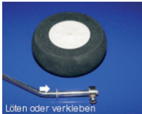
Löten, oder kleben Sie mit 5Min. Epoxydharz eine Unterlegscheibe zur Radarretierung auf die Radachsen. Nun können die Räder aufgeschoben und mit den Stellringen gesichert werden. Zur Leichtgängigkeit des Radlaufes sollten die Achsbohrungen vorsichtig etwas aufgebohrt werden. Das Hauptfahrwerk in die vorhandenen Rumpfbohrungen einstecken und die Metallaschen mittig über den Fahrwerksdraht mit Holzschrauben verschrauben. Es empfiehlt sich hier vorher mit 1,5mm vorzubohren.
