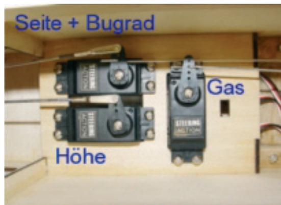
Den Einbau der Servos und Ausrichtung der Servosteuerarme können Sie dem obigen Foto entnehmen. Die mitgelieferten Gestänge müssen Servoseitig auf entsprechende Länge gekürzt werden. Löten Sie hier die Gabelköpfe direkt auf das Gestänge.
