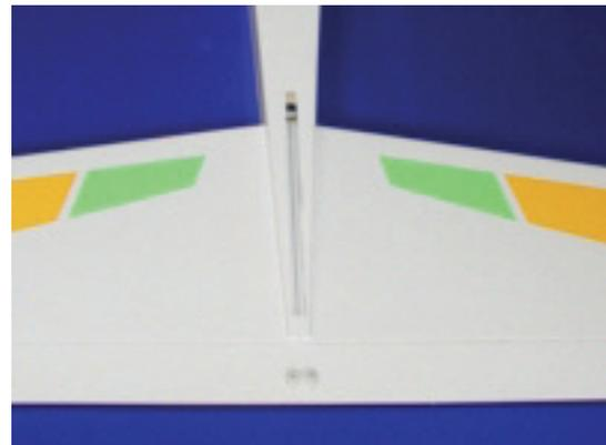
Ermitteln Sie zuerst mit Hilfe eines Lineals die genaue Mitte vom Höhenleitwerk und zeichnen Sie diese gut sichtbar mit einem Filzschreiber an. Mit Hilfe dieser Linie können Sie das Höhenleitwerk am Rumpf durch den Blick in den Seitenleitwerksausschnitt mittig ausrichten. Fixieren Sie das ausgerichtete Höhenleitwerk mit einigen Baunadeln am Rumpf.
