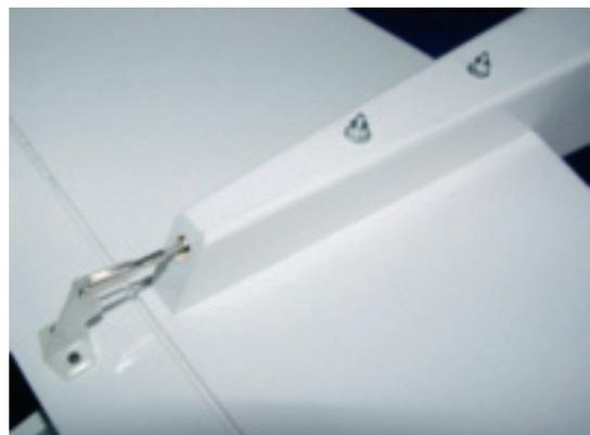
Die Gestängedurchführung für das Seitenleitwerk im Rumpf muss vorher freigelegt werden. Die Gabelköpfe aufdrehen, und in die Ruderhörner vom Höhen, sowie Seitenleitwerk Einclipsen.
