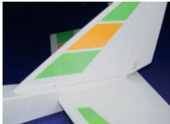
Jetzt kann das Leitwerk in die Seitenleitwerksöffnung eingesteckt, und mit den mitgelieferten Unterlegscheiben sowie M3 Stopmuttern das vereinfachte **arkai-Befestigungsgestänge** auf der Rumpfunterseite verschraubt werden.
