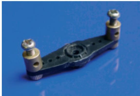
Bestücken Sie einen doppelseitigen Servosteuerarm mit den beiliegenden Gestängenschlüssen. Bitte beachten Sie, dass diese Anschlüsse leicht drehbar sein müssen, und sichern Sie die Muttern gegen lösen mit Schraubensicherungslack!
