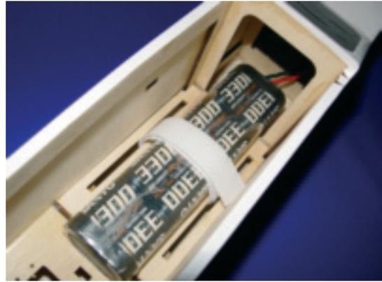
Einkleben des Sperrholzteil für die Aufnahme der Antriebsbatterie. Mit dem mitgelieferten Klettband wird die Antriebsbatterie gegen ein verrutschen gesichert.
